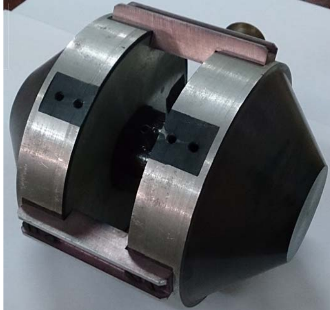
Рис. 2. Фокусувальна система на постійних магнітах з полюсами профілюваної форми розробки ІРЕ ім. О.Я. Усикова НАН України.
