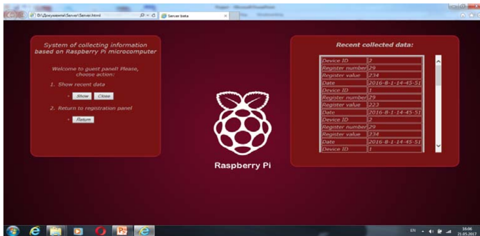
Рис. 8. Вікно інтерфейсу web-сайту для віддаленого керування вимірювальними пристроями.
