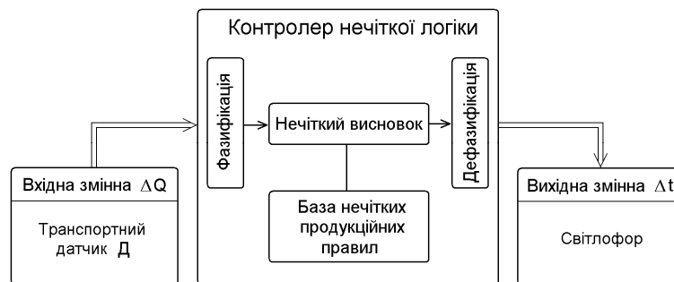
Рис. 2. Схема системи керування транспортним потоком на основі контролера нечіткої логіки.
