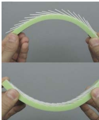
Рис. 10. Поведінка поверхневого покриття матеріалу у вигляді луски під час деформації вигину [17].
