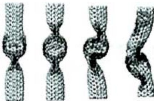
Рис. 7. Деформації вуглецевих нанотрубок у напрямі, перпендикулярному до осі трубки [13].
