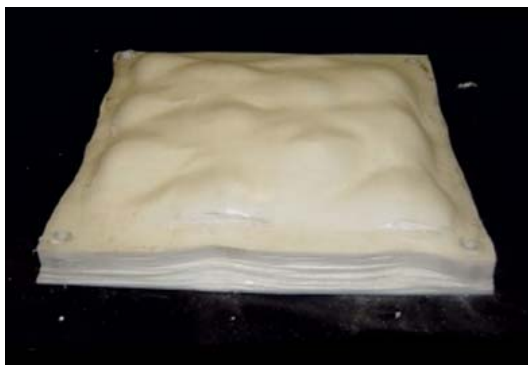
Рис. 9. Поліетиленова броня “Tensylon” [16].
