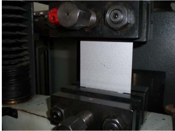
Рис. 1. Загальний вигляд шаруватого композитного матеріалу, закріпленого в кінцєвиках універсальної розривної машини FPZ-10/1
