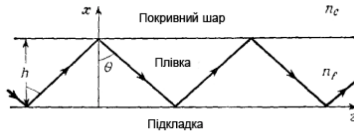
Рис. 1. Вигляд збоку на планарний хвильовід і напрям нормалей до хвильових поверхонь зигзагоподібних хвиль; n_f , n_c , n_s – показники заломлення хвильовідного і покривного шарів та підкладки, відповідно, h – товщина хвильовідного шару.
